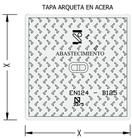
Nota - La resistencia mecánica de las tapas estará en función del tráfico rodado (B-125-C250-D400)
